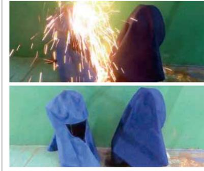
GR-Tecは、スパッタや液化金属飛まつが附着しにくいため、衣類への損傷が少なく着火を防ぎます。もし生地に着火しても炭化するため燃え広がりを抑えます。
