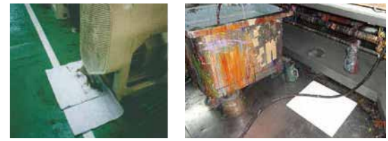
工場の床などへ流出した油の除去 工場用の機械から流出した油の除去 等
